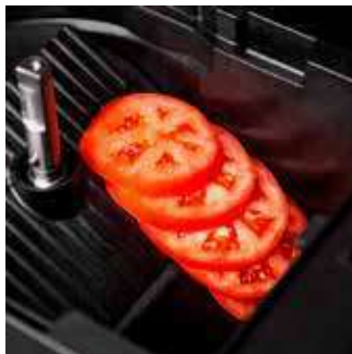
Provista de rampa para la expulsión del producto por la gravedad.
