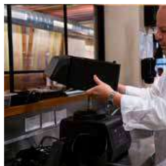
Cabezal, tapa y caldero fácilmente desmontables.
