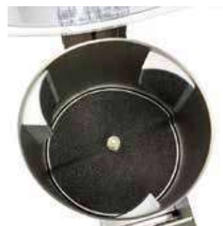
Revolvedores laterales y plato abrasivo.
